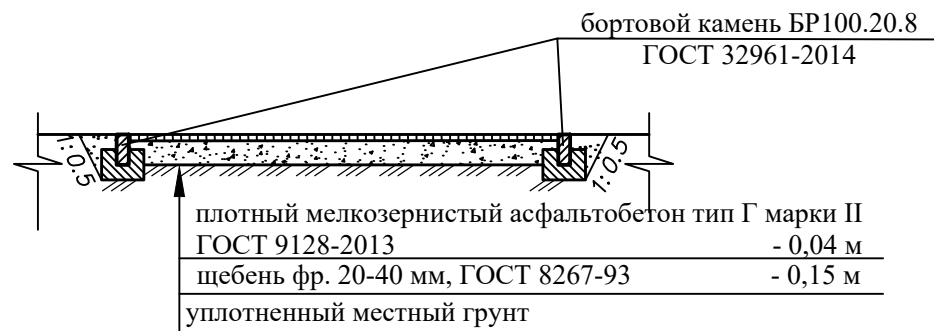
Конструкция дорожной одежды тротуара
